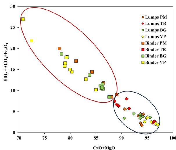
Fig. 1 - CaO + MgO vs. SiO<sub>2</sub> diagram (EDS), lumps (blue circle) and binder (red circle), PM: Piscina Mirabilis, TB: Terme di Baia; BG: Villa del Capo; VP: Villa del Pezzolo.
